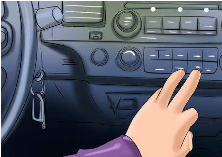
Hình 3-21: Tắt hệ thống điều hòa không khí
