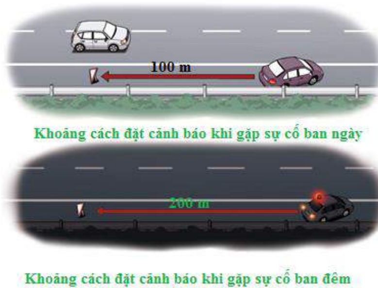
Hình 3-40: Khoảng cách đặt vật cảnh báo khi dừng xe khẩn cấp trên đường cao tốc
