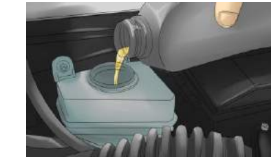
Hình 8.12: Kiểm tra bổ sung dầu phanh
