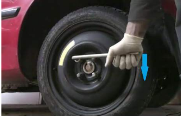
Hình 7.13: siết chặt các ốc lắp bánh xe
