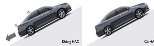
Hình 3-36: Hệ thống hỗ trợ khởi hành ngang dốc
