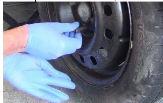
Hình 7.11: lắp các e cu bánh xe
