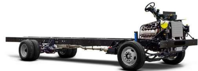
Hình: 1-10 Hệ thống gầm xe tải
