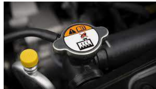
Hình 8.3: Cảnh báo không được mở nắp két nước khi nước trong két còn nóng sôi.
