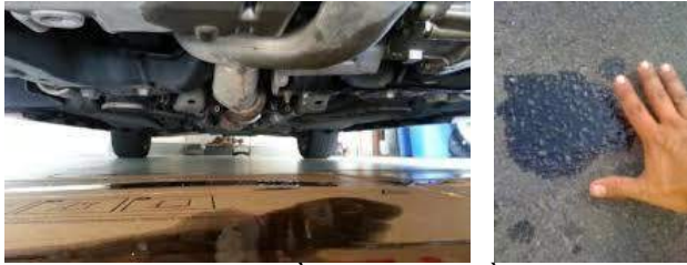
Hình 6.3: dầu rò rỉ dưới gầm xe
