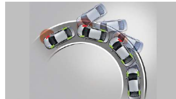
Hình 3-35: Hiệu quả của hệ thống ổn định chuyển động.
