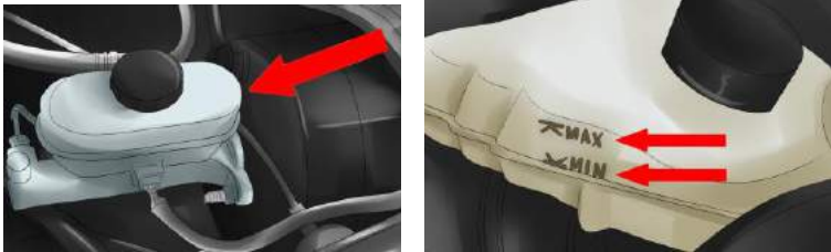
Hình 6.11: Kiểm tra, bổ sung dầu ly hợp
