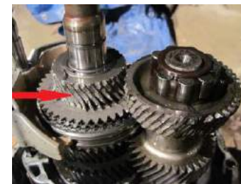
Hình 6.13: Bánh răng của hộp số bị xứt
