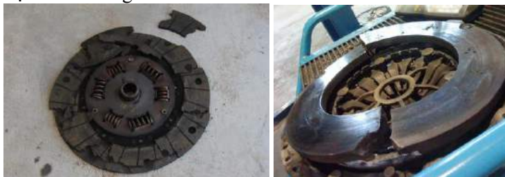
(a) (b) Hình 6.12: Hỏng ly hợp (a) hỏng đĩa ly hợp; (b) hỏng bàn ép
