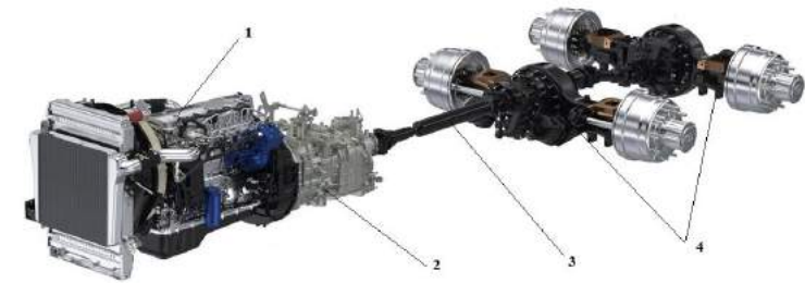
Hình 3-1đ: Hệ thống truyền lực trên xe tải cỡ lớn hai cầu sau chủ động
