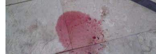
Hình 6.6: dầu rò rỉ từ hộp số tự động
