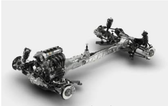
Hình 1-11: Hệ thống gầm xe con
