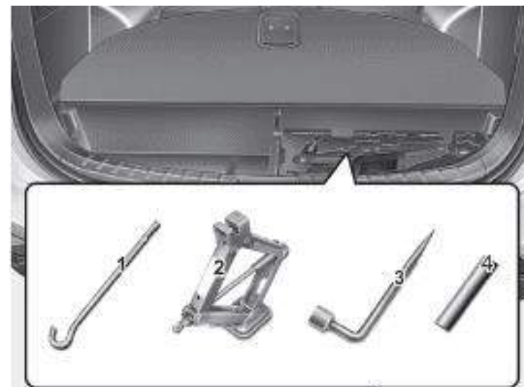
Hình 7.2: Bộ đồ nghề cần mang theo xe 1-tay quay kịch; 2-kịch; 3,4 tuýp tháo lốp
