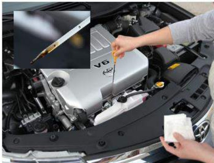
Hình 8.2: Kiểm tra mức dầu động cơ
